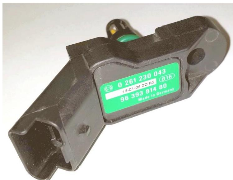
این سنسور تشکیل شده از دو سنسور فشار و دمای هوای ورودی است که محل قرارگیری آن در مسیر هوا رسانی بر روی منیفولد هوا می باشد.
