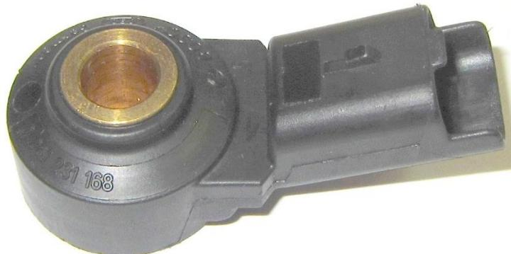
اگنان پائین سوخت، زمان جرقه خیلی آوانس ، نسبت تراکم بالا و دمای بالای هوای ورودی از عوامل ایجاد ناک می‌باشند. اشکالات پدیده ضربه: باعث کاهش کارایی و قدرت موتور و افزایش انرژی و فشار حرارتی می‌گردد. در نتیجه باعث بوجود آمدن فشار حرارتی زیادی روی واشر سر سیلندر و پیستون و اطراف سوپاپ‌ها شده و آسیب دیدگی سیستم را بوجود می‌آورد. این پدیده وقتی بوجود می‌آید که مخلوط سوخت و هوای جدید در قسمت بالای سیلندر قبل از رسیدن جرقه شمع منفجر شود. این احتراق ناخواسته را خود سوزی (مخلوط محترق نشده) می‌گویند.
