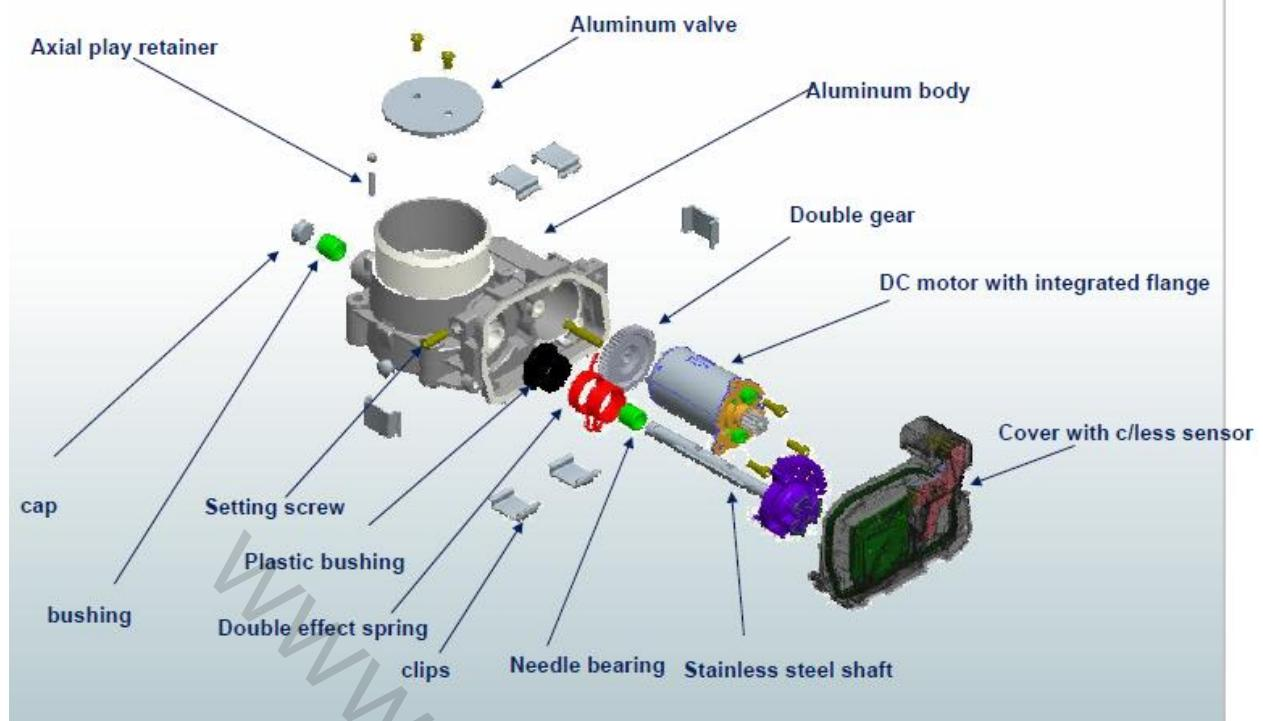
اتصالات دریچه گاز (ETC)
