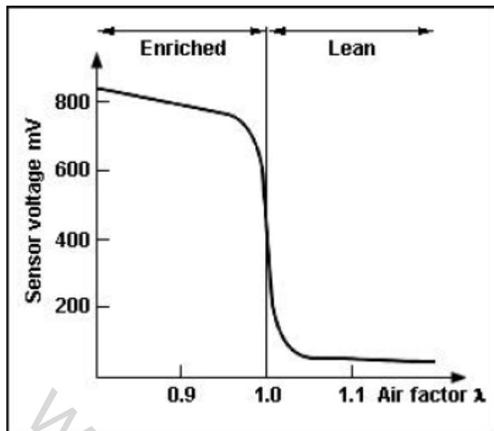
ولتاژ در محدوده ۵۵/۰ تا ۹/۰ ولت: مخلوط غنی
