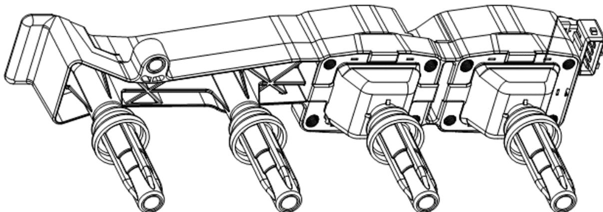
سیم پیچ جرقه از دو سیم پیچ تشکیل شده است که هسته آهنی به هم جفت شده اند. انرژی توسط سامانه الکتریکی خودرو در زمان شارژ در سیم پیچ ذخیره می شود. در لحظه زدن جرقه انرژی در ولتاژ بالای مورد نیاز آزاد شده و به شمع خواهد رسید.
